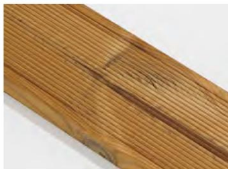
Malé pozdĺžne trhliny na povrchu sú povolené.
